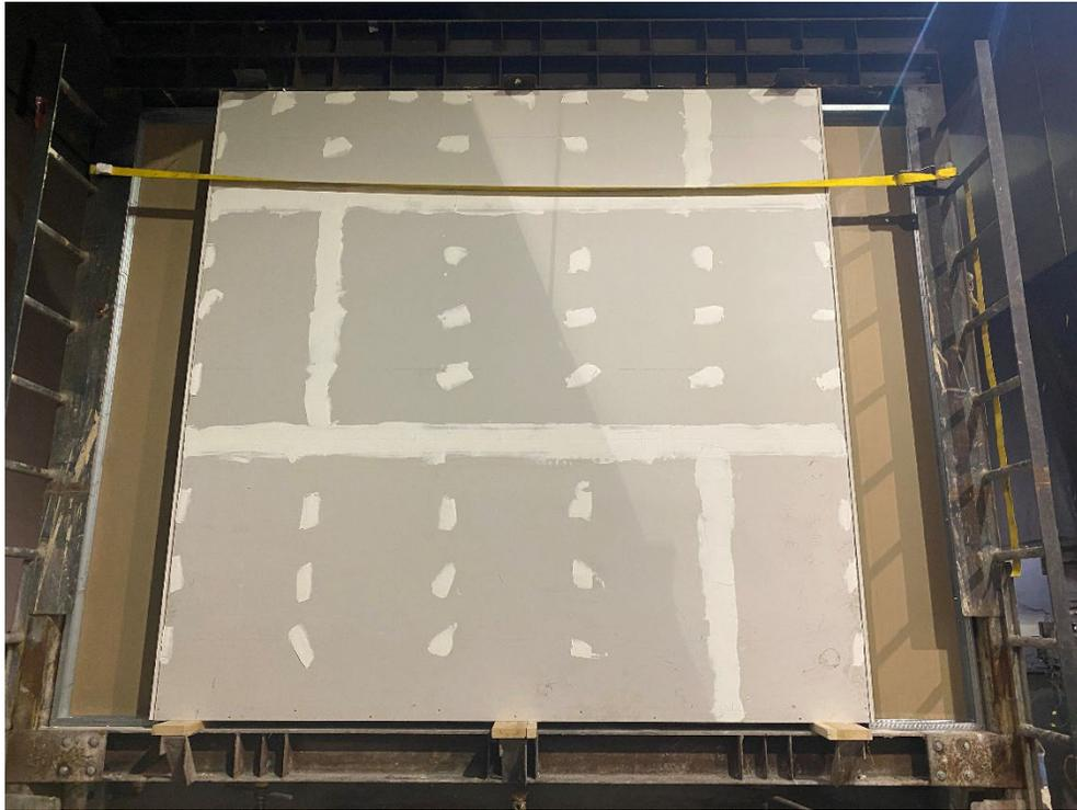
**Illustration 7:** Surface non exposée avant le test d'endurance au feu.
