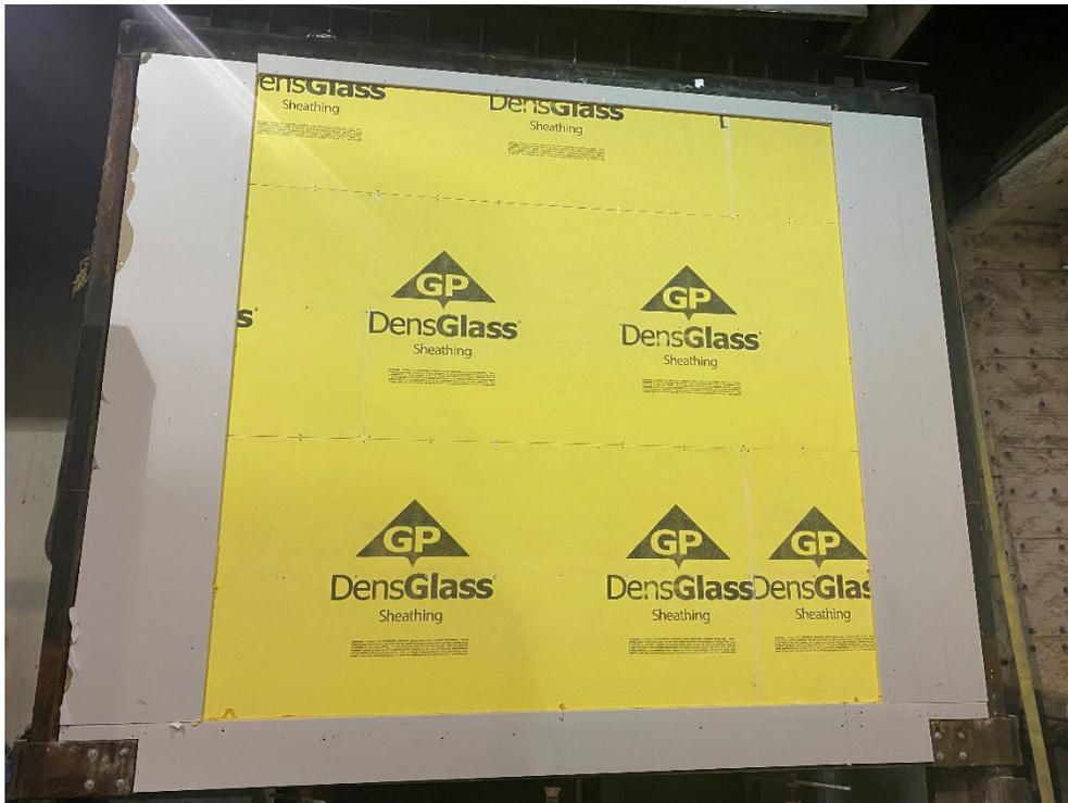
**Illustration 8:** Surface exposée avant le test d'endurance au feu.
