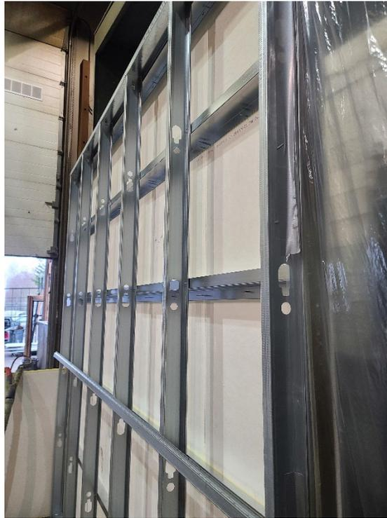
**Illustration 5:** Surface non exposée avant l'application de la mousse.
